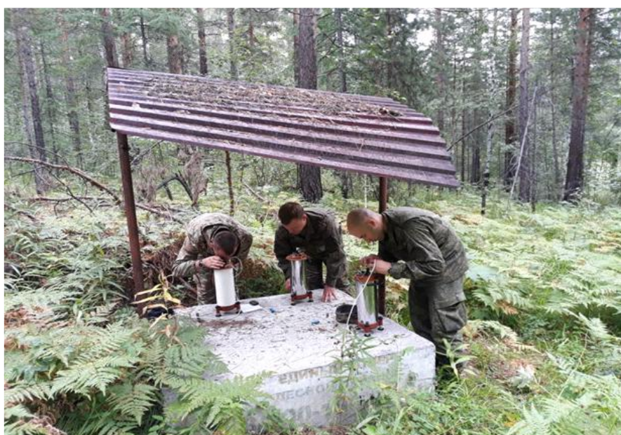
Рис. 2. Эталонирование гравиметра на эталонном гравиметрическом пункте № 3
