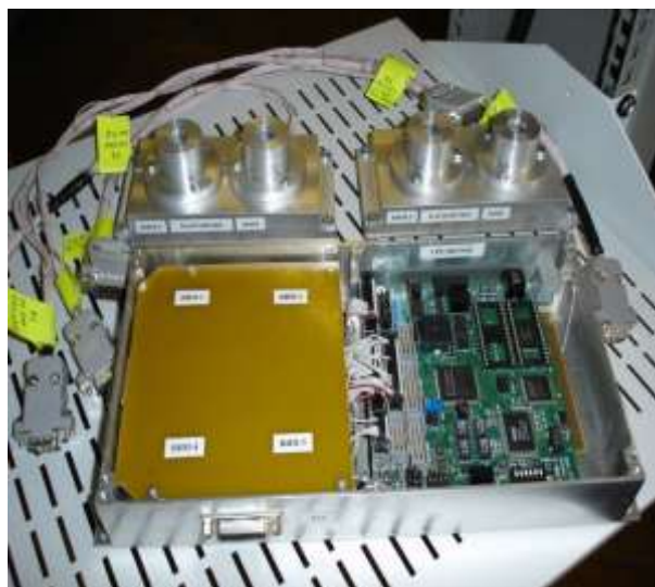
Рис. 3. БФП и БМК бортовой аппаратуры «Облик-2» МКА «Можаец-5»
